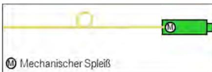
Abbildung 35: Prinzipdarstellung eines Steckers mit integriertem mechanischem Spleiß (Quelle: DT)
