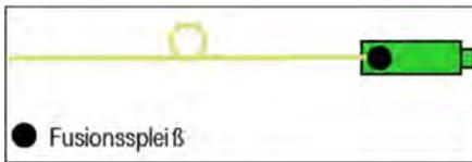
Abbildung 33: Prinzipdarstellung zur Konfektionierung eines „Spleißsteckers“ an ein Kabelende (Quelle: DT)
