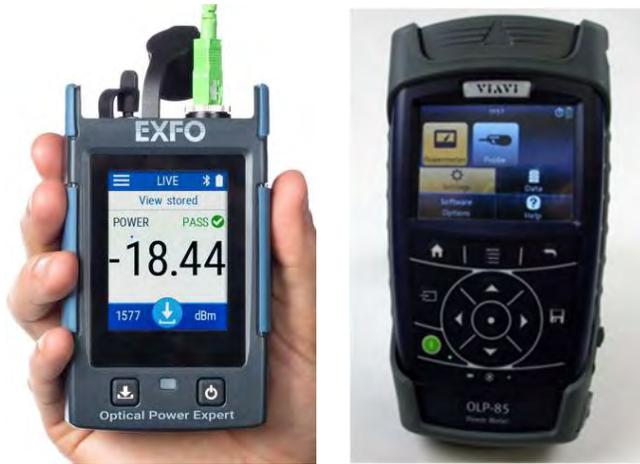
Abbildung 48: Beispiel Optischer Pegelmesser (Quellen: links Fa. 3 Edge/ Fa. EXFO; rechts Fa. VIAVI)
