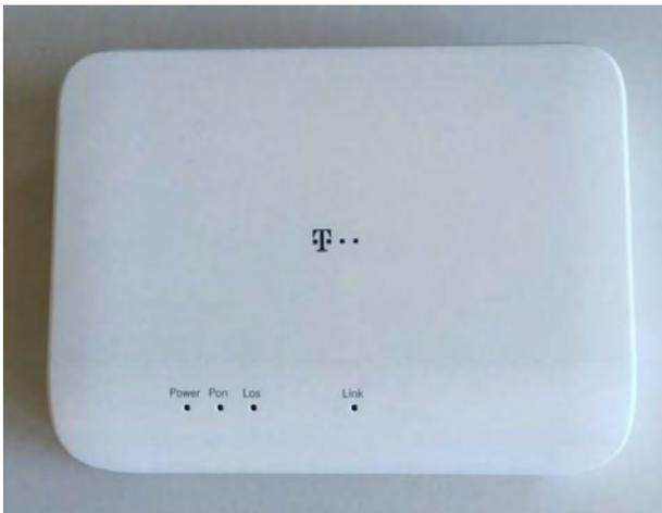
Abbildung 46: Glasfaser-Modem (ONT) (Quelle: DT)
